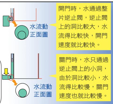
這樣就可用液壓系統開門，取代電動門了。
